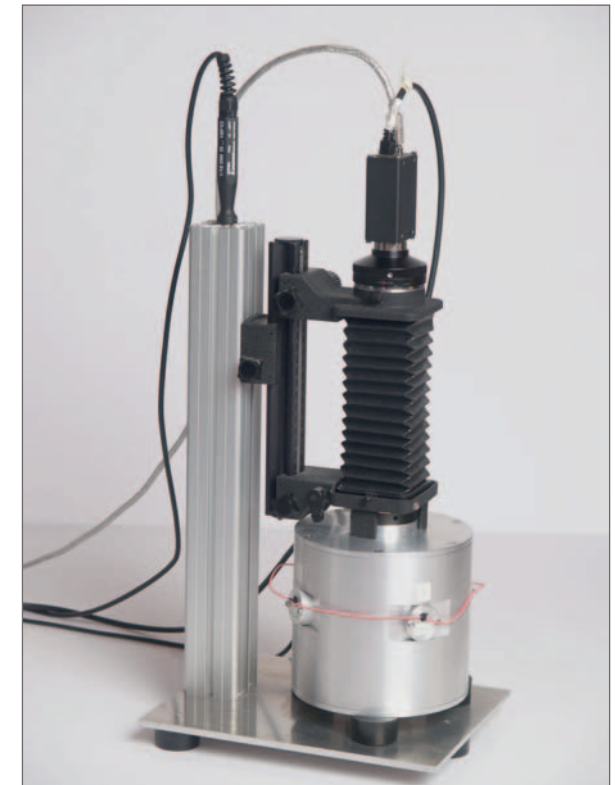
EMVA 1288 Messeinrichtung mit Ulbrichtkugel
